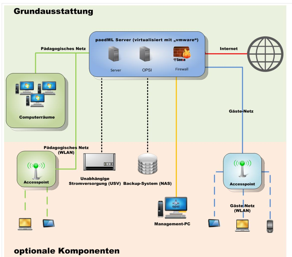
Abb. 2: Schematische Darstellung der Netzwerkstruktur der paedML® für Grundschulen
