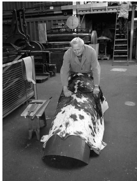
Vorgang des Schabens auf einem Schabbaum aus Metall.
